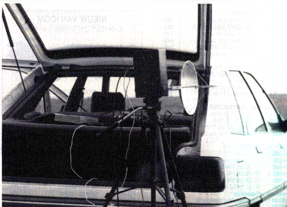
47 GHz portable opstelling bij Almere. Op het statief het 47 GHz zend/ontvangdeel. In de auto de 2-meter achterzet. (foto: PAoEHG).
